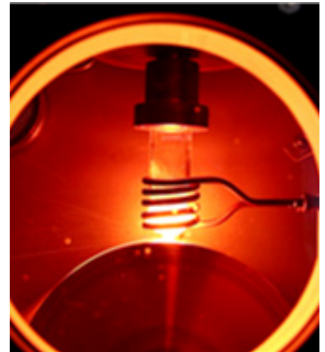
Der Rascherstarrungsprozess lässt Flakes mit sehr feiner Mikrostruktur entstehen. Dabei wird das Material eingeschmolzen und anschließend durch eine Düse auf ein schnell rotierendes, wassergekühltes Kupferrot gespritzt. [Quelle: Fraunhofer IWU]
